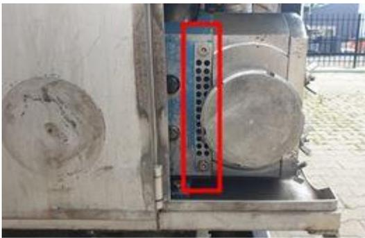
Haz una marca con un bolígrafo si es necesario, para saber hacia qué lado debes mover la palanca del control de la bomba para el sentido de giro correcto.
