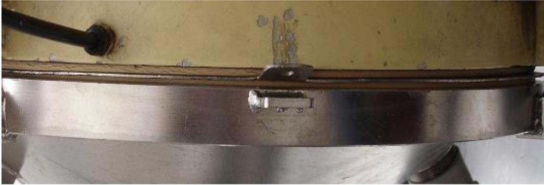
El fondo de descarga está apretado uniformemente y el anillo agitador está montado.
