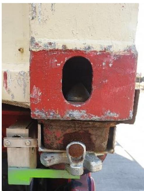
Twistlock con 'contactos de cierre'. El twistlock debe estar completamente cerrado, de lo contrario el motor basculante se cortocircuitará. Es imposible bascular si el twistlock no está cerrado y ambos puntos no hacen buen contacto. La suciedad y el agua también impiden un buen contacto.
