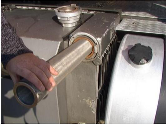
Asegúrate de que el filtro del compresor de carga seca (si está presente) esté limpio y colocado en la carcasa. Si este filtro no está limpio, debe informarse al planificador. El filtro debe ser limpiado. La presencia de aceite puede indicar una fuga interna del compresor.
