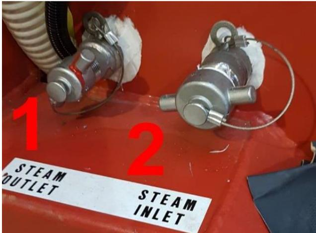
Sorgen Sie dafür, dass die Gewinde der Dampfleitungen mit Teflonband versehen sind und dass Stucchi-Schnellkupplungen vorhanden sind.
