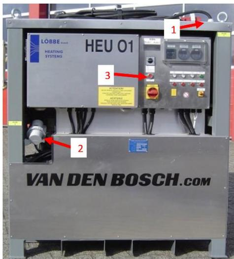
1. Stecker 1 Master (380-V-Anschluss für den Anschluss *eines* Containers)
