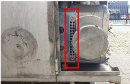
Markieren Sie gegebenenfalls mit einem Stift, damit Sie wissen, in welche Richtung Sie die Pumpensteuerung für die korrekte Drehrichtung bewegen müssen.
