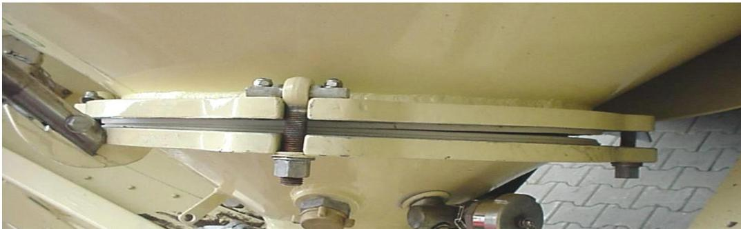
Der Entladeboden ist schräg verschlossen. Gummi auf Gummi: Die Auflockerung fehlt.
