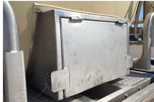
Auslasskasten an beiden Seiten versiegeln
