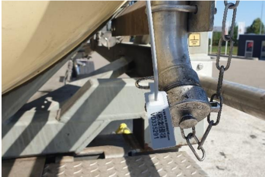
2" BSP-Blindkappe an der Luftleitung
