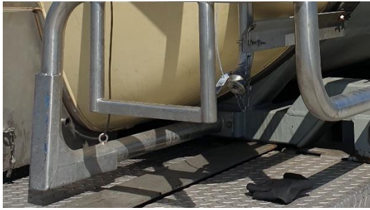
Zollseil über Auslass im Auslasskasten Blindkappe BSP 3" lose
