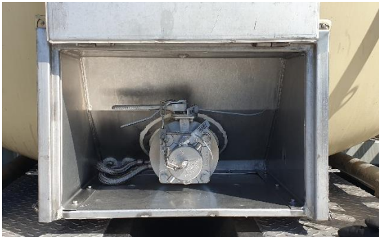
Absperrklappe und 3" BSP-Blindkappe am Auslass
