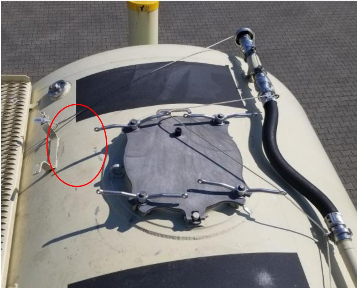
**Oberseite:** Das Zollseil ist vollständig von der Spule abgewickelt. Die Befestigungsöse muss an der Spule versiegelt werden. Das Zollseil wird durch das Vakuumventil (Deckel gut zudrehen) und durch das Rückschlagventil der oberen Luftleitung geführt, dann diagonal durch die Ringe der Mannlochdeckelverschraubungen.
