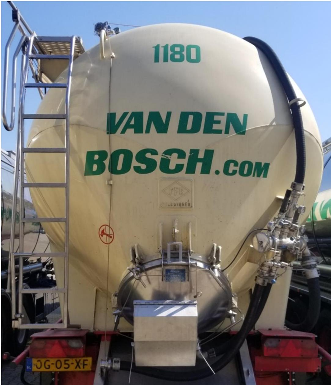
**Rückseite:** Das Zollseil muss durch die Ringe auf der Rückseite der Ladeeinheit, dann durch die Ringe aller Verschraubungen des Entladebodens und schließlich durch die Ringe des Transportluftschlauchs geführt werden. Sie enden am Versiegelungspunkt des Auslasskastens mit einer Plombe. Der Auslasskasten (falls vorhanden) wird auf beiden Seiten versiegelt.
