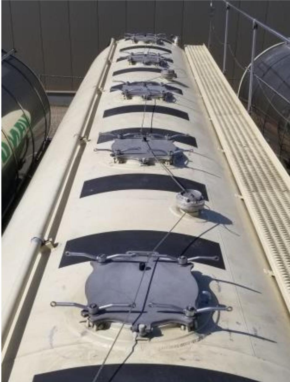
**Oberseite:** Das Zollseil muß diagonal durch die Verschraubungen gezogen werden. Die Storz-Blindkappen dürfen dabei nicht ausgelassen werden. Achten Sie darauf, die Blindkappen mit einem Siloschlüssel/ABC-Schlüssel fest anzuziehen. Sorgen Sie dafür, dass Sie den Schlüssel mitnehmen, wenn Sie auf das Silo steigen.
