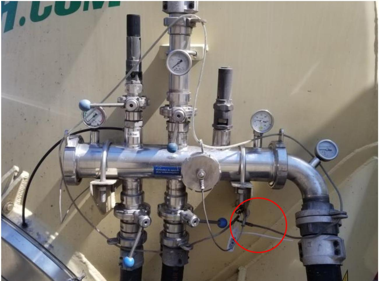
**Rückseite:** Versiegelung des Luftverteilers mit Zollseil. Beide Enden des Zollseils müssen mit einer Plombe verbunden und versiegelt werden. Die Plombe wird durch beide Ösen des Zollseils geführt.
