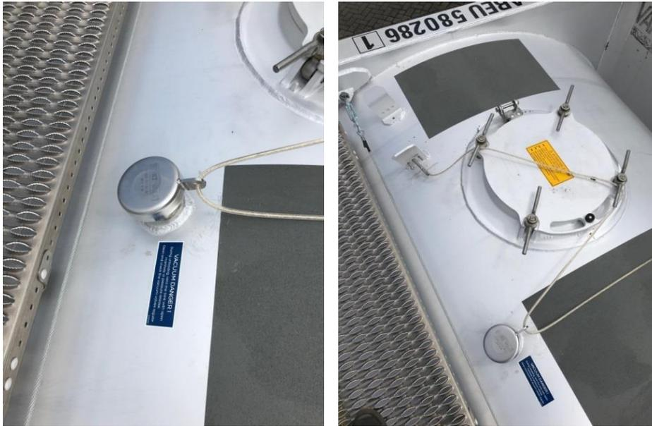
Stellen Sie sicher, dass das Vakuumventil fest zuge dreht ist.
