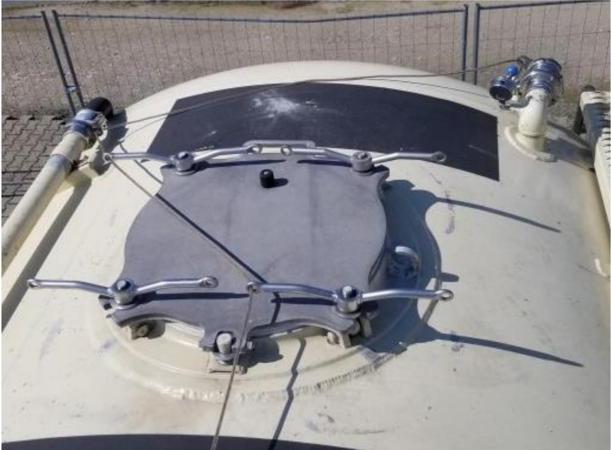
**Oberseite:** Lassen Sie das Zollseil hinten in Richtung des Rückschlagventils der oberen Luftleitung „laufen“. Damit vermeiden Sie Schäden am Zollseil.
