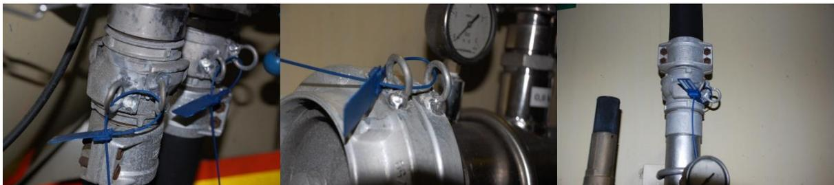
**Rückseite:** Versiegelung des Luftverteilers ohne Zollseil. Die meisten Luftverteiler haben Versiegelungspunkte mit zwei Ringen. Deshalb wird für jeden Versiegelungspunkt eine Plombe verwendet.
