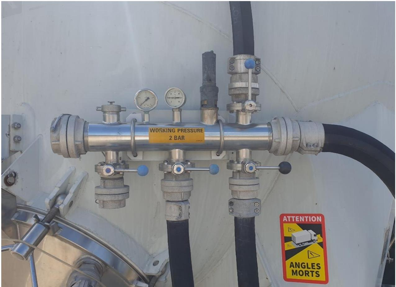
**Rückseite:** Luftverteiler ohne Versiegelungspunkte. Dies tritt nur bei chemischer Fracht auf.
